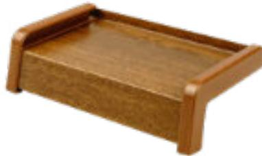
Fensterbank aus verzinktem Stahl mit PVC-Folie. Hergestellt aus 0,7 mm dickem Blech mit Zinkbeschichtung 275 g/m<sup>2</sup>. Die Fensterbank kann bis zu einer maximalen Länge von 6 m hergestellt werden, wobei der Breitenbereich: 100–400 mm.
