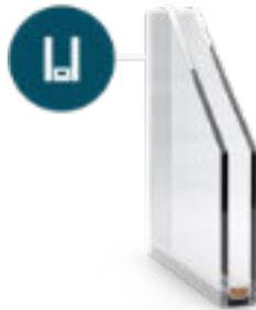
2-Fach Verglasung, besteht aus zwei Glasscheiben. Dies ist Standard für einfache Fenster- und Türsysteme. In dem Raum zwischen den vom Abstandhalter erzeugten Scheiben befindet sich hauptsächlich Argon (90%), was den Wärmeübergangskoeffizienten  $U_g$  weiter verringert.
