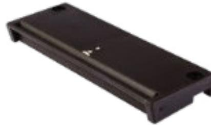
Ein Falz-Lüfter, der im inneren Teil des Rahmens platziert wird, so dass er bei geschlossenem Fenster fast unsichtbar ist. Durch den Einbau besteht die Möglichkeit eines Luftstroms an der Stelle, an der er sich befindet. Luftströmung (für zwei Lüfter) bei 10 Pa:  $5 \text{ m}^3/\text{h}$ . Schalldämmung:  $D_{n,e,w} = 34 \text{ dB}$ .
