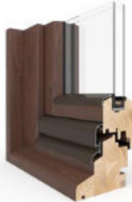
Ein Profil mit verlängerter Einbautiefe, das einen ästhetischen Einbau des Fensters in die Wärmedämmschicht ermöglicht, ohne dass zusätzliche Wärmebrücken entstehen.
