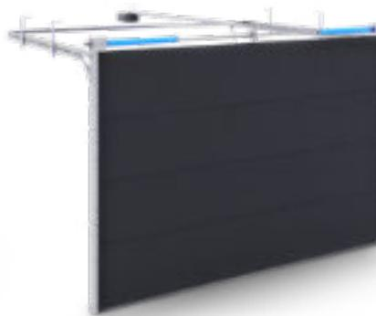
Drehfeder werden für etwas größere Torelemente empfohlen. Dieses System ist im Stande eine höhere Last zu heben bzw. zu öffnen. Die Montage mit Drehfedern von vorne ist nur möglich, wenn der Sturz min. 200 mm hoch ist. Die maximale Last beträgt 195 kg.
