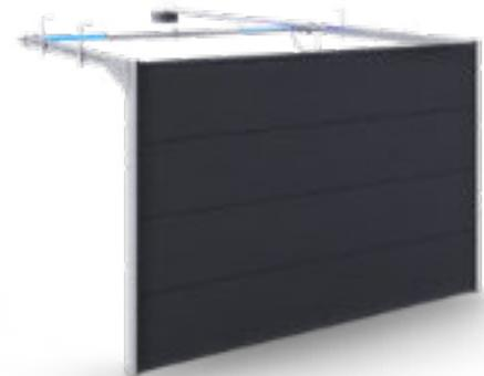
Ein Tor mit Drehfedern von hinten erlaubt die Montage in einer Nische mit einem niedrigen Sturz. In diesem Fall reicht es, wenn der Sturz 70 mm beträgt (100 mm im Fall bei einem Motorantrieb). Die maximale Last beträgt 195 kg. Dieses System ist auch für Renovationen gedacht.
