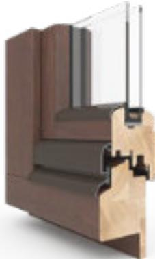
Profilversion, die den Einbau neuer Fenster in bestehenden Gebäuden ermöglicht, ohne dass alte Holzrahmen entfernt werden müssen. Es sind verschiedene Längen der Flosse erhältlich, die den alten Rahmen im Inneren des Gebäudes abdeckt.
