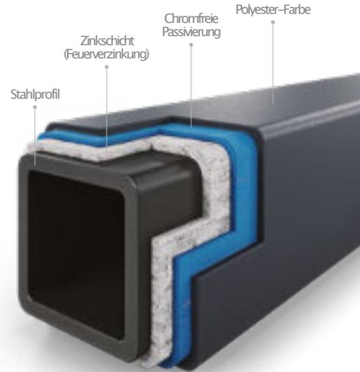
Stahlzäune sind feuerverzinkt, was einen hervorragenden Korrosionsschutz gewährleisten.
