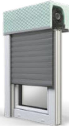
Eine fortgeschrittene Systemlösung für neue und instandgesetzte Gebäude. Verbessert im Bereich des Sturzes, mit raumseitiger Revisionsöffnung für Dichtheit der ganzen Konstruktion. Das Schaumprofil erhöht die Abdichtung und verhindert, dass im Deckel thermische Brücken entstehen.
