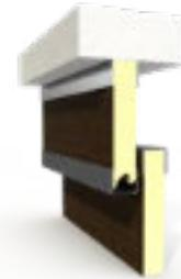
Imitation des Sturzes, um die Struktur zu verdecken, unter Verwendung von Türpaneelmaterialien.
